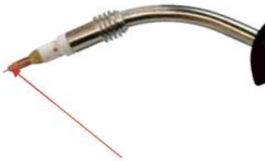
(13) Coloque los consumibles para aluminio del diámetro correcto del alambre a usar.
