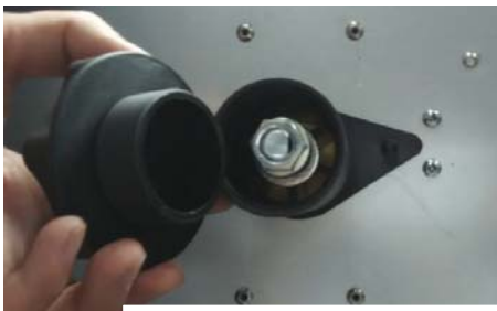
Retire la tuerca de retención del carrete
