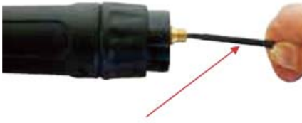
(5) Cuidadosamente coloque el liner sin doblarlo
