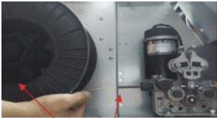
(12) Coloque la bobina de alambre de aluminio
