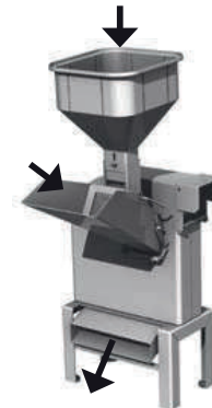
El producto es colocado en el pico de alimentación o tolva y sale por el pico inferior.
