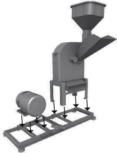
Colocar la máquina y el motor sobre la base.
