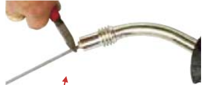
(6) Coloque la abrazadera, el o 'ring y la tuerca
