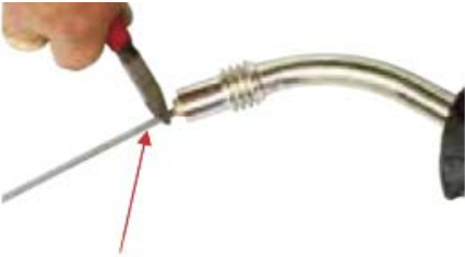
(7) Corte el liner a 3 mm del extremo del cuello de la torcha
