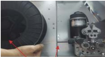
(12) Coloque la bobina de alambre de aluminio
