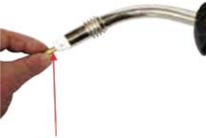
(9) Coloque los consumibles para el tipo de alambre y el diámetro que utilizara.
